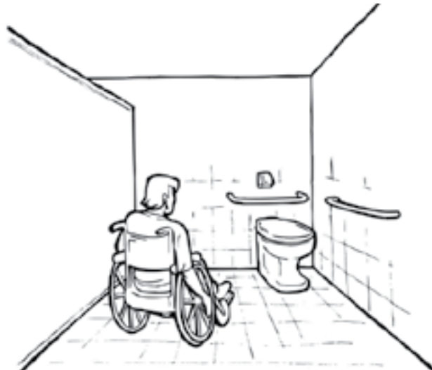
Banheiro possibilitando área de transferência lateral ou diagonal
