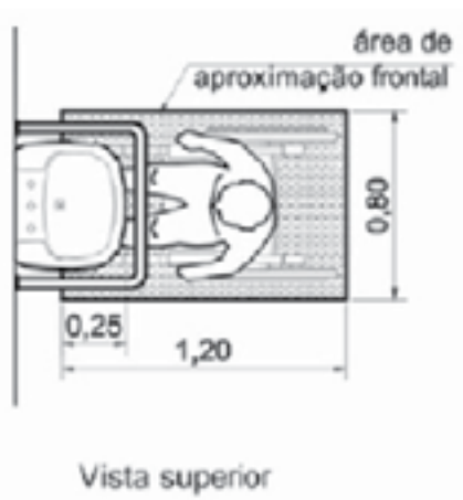
Pia com área de aproximação frontal para uma pessoa sentada. Fonte: ABNT – NBR 9050/2004.
