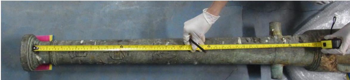
Figura 16 - A fotografia acima retrata a medição que considera a extensão do tubo, propriamente. A medida é de 1m e 7 cm aproximadamente
