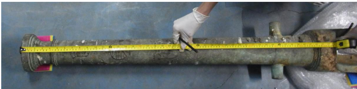
Figura 15 - A fotografia acima retrata a medição que considera a extensão do tubo desde a boca até a abertura traseira. A dimensão é de 1m e 16 cm aproximadamente
