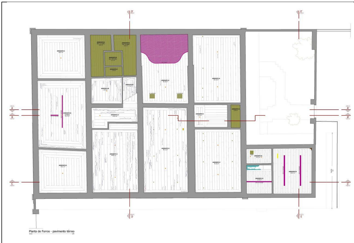
Figura – Padrão de representação para o mapeamento de danos no planta de forro.
